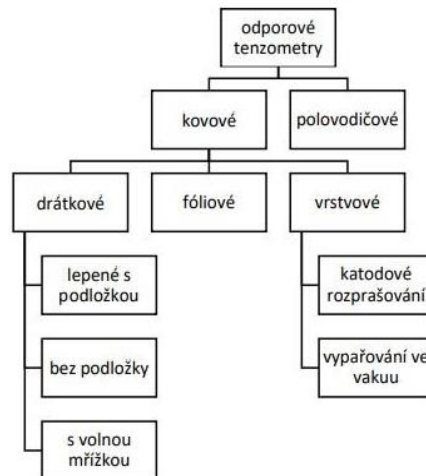
Obrázek 2: Dělení odporových tenzometrů (Varinský, 2018)
