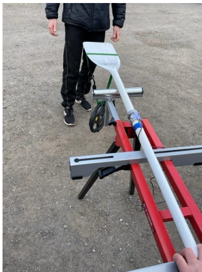
Obrázek 7: Kalibrace pádla pomocí závaží
